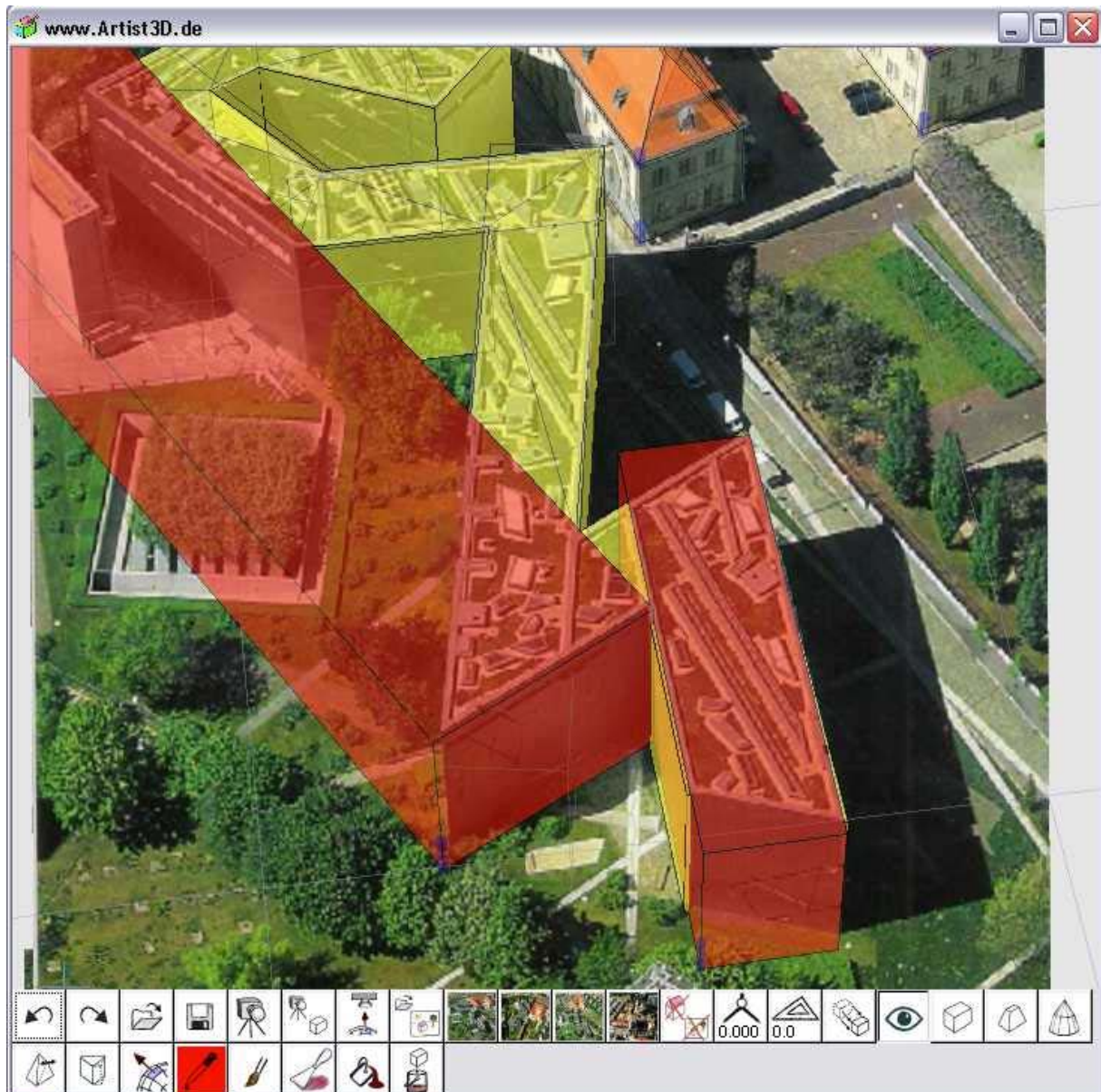
Abbildung 2: Später ausgeblendete Quader-Objekte (rot ) und modelliertes Prisma-Objekt (gelb)
